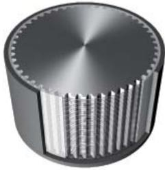
Polyurethan-Formzahnriemen (Wickelriemen) werden endlos mit einem spiralförmig aufgewickeltem Stahl oder Aramidzugträger und duroplastischem Polyurethan in speziellen Formen gegossen. Durch die hohe Teilungsgenauigkeit über den gesamten Riemen liefern Formzahnriemen erstklassige Leistung für Kraftübertragung und lineare Anwendungen, eignen sich besonders für einen ruhigen Lauf und hohe Drehzahlen.
