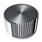
**Neoprene Formzahnriemen** (Wickelriemen) werden in speziellen Formen vulkanisiert. Durch die hohe Teilungsgenauigkeit über den gesamten Riemen sind sie besonders geeignet für einen ruhigen Lauf und hohe Drehzahlen.
