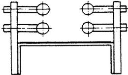
Führung höhen- und seitenverstellbar aus Rundmaterial St 37 oder V2A
