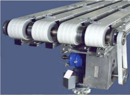
Zahnriemenförderer eignen sich für genaue Positionierung im Taktbetrieb, bei Einsatz in allen Montagebereichen
