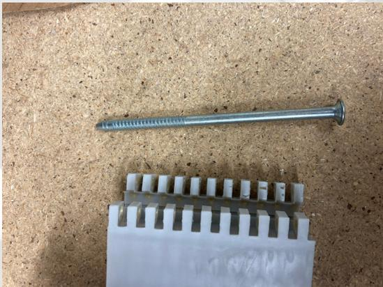
Die Zähne müssen exakt zueinander ausgerichtet sein, um Beschädigungen der Zugstränge beim eindrehen des PIN zu vermeiden. Fehlausrichtungen der Zähne oder die Verwendung eines nicht angeschrägten PIN's können bei der Montage die Zugstränge beschädigen. Die easy joint Verbindung ist nicht zum mehrmaligen öffnen und schließen geeignet.
