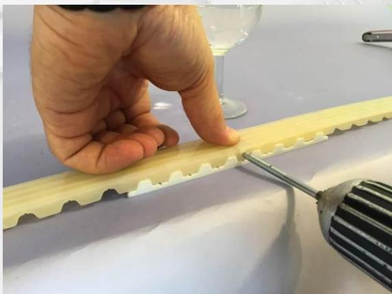
Den PIN mit einem elektrischen Schraubendreher und Wasser (als Schmiermittel) in die Verbindung eindrehen. Für eine korrekte Ausrichtung, verwenden Sie bitte eine Gegenplatte/-stück.
