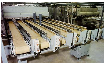
Offenmaschiges Transportband zur Garnfixierung
