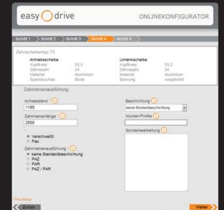
4. Für Zahnriemen Dimensionen, Spezifikation sowie Veredelung festlegen.
