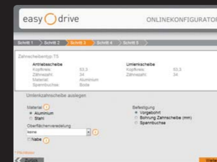
3. ... Umlenkscheibe in Art und Ausführung definieren.
